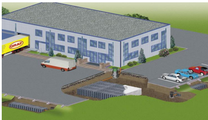
Obr. 2 Také u velkoplošných staveb se doporučuje vyžadovat jako vyvolané investice budování podzemních zasakovacích, případně podzemních nebo povrchových nádrží [GRAF].
