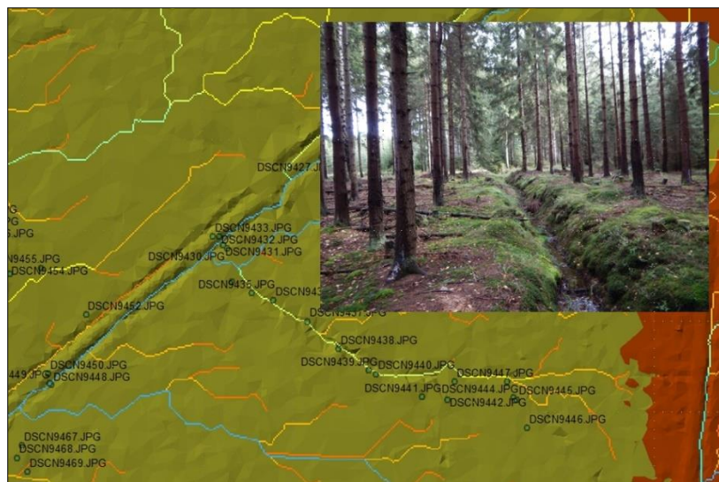
Obr. 2 Příklad trasování odvodňovacích příkopů podle odtokových linií z terénu DMR 5G
