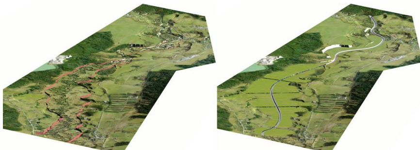
Obr. 4 Vizualizace modelovaných scénářů úseků Lužnice, vlevo původní členitá niva s ohrázováním aktivní zóny (scénář F), vpravo upravená niva a kapacitní koryto s příčnými hrázkami (scénář G), pohled proti toku
