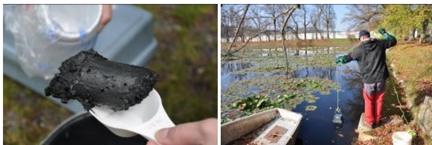
Obr. 2 Sediment z odběru trubkovým odběrákem (vlevo) a odběr Ekmanovým drapákem (vpravo)
