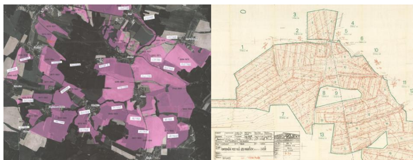
Obr. 3 Příklad přehledné situace s přiřazením dohledaných archivních složek PD (Zhoř u Tábora) – vlevo je znázorněna práce archiváře při přiřazení dohledané složky písemnosti PD k evidenci stavby v podkladech ZVHS (fialové polygony reprezentují plochy staveb odvodnění a na bílém listěčku je přiřazena složka PD); vpravo: část naskenovaného výkresu stavby odvodnění z r. 1972 (zdroj: ZVHS, s.p. PVL)
