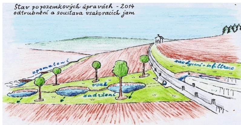
Obr. 11 Stav po realizaci soustavy opatření záchytného příkopu, vsakovacích jam, revitalizace toku a ochranného zatravnění (Mazín, 2016)
