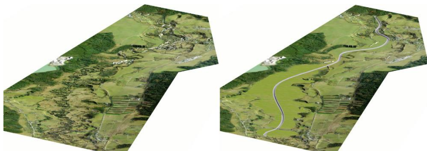
Obr. 3 Vizualizace modelovaných scénářů úseků Lužnice, vlevo původní členitá niva (scénáře A, B, C), vpravo upravená niva a kapacitní koryto (D, E), pohled proti toku
