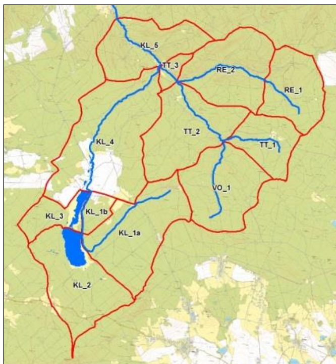
Obr. 1 Rozdělení zájmového povodí na dílčí povodí
