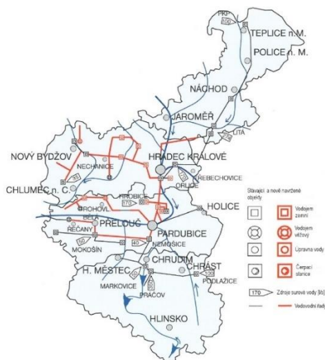
Obr. 1 Schéma Vodárenské soustavy Východní Čechy
